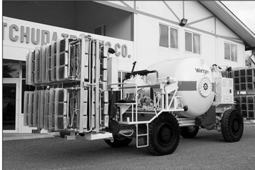
Рисунок 2 – Терморазогреватель дорожного покрытия с газовыми горелками инфракрасного излучения
