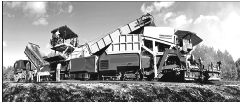
Рисунок 6 – Асфальтоукладочный комплекс для одновременной укладки двух слоев асфальтобетонного покрытия по технологии «компакт-асфальт»
